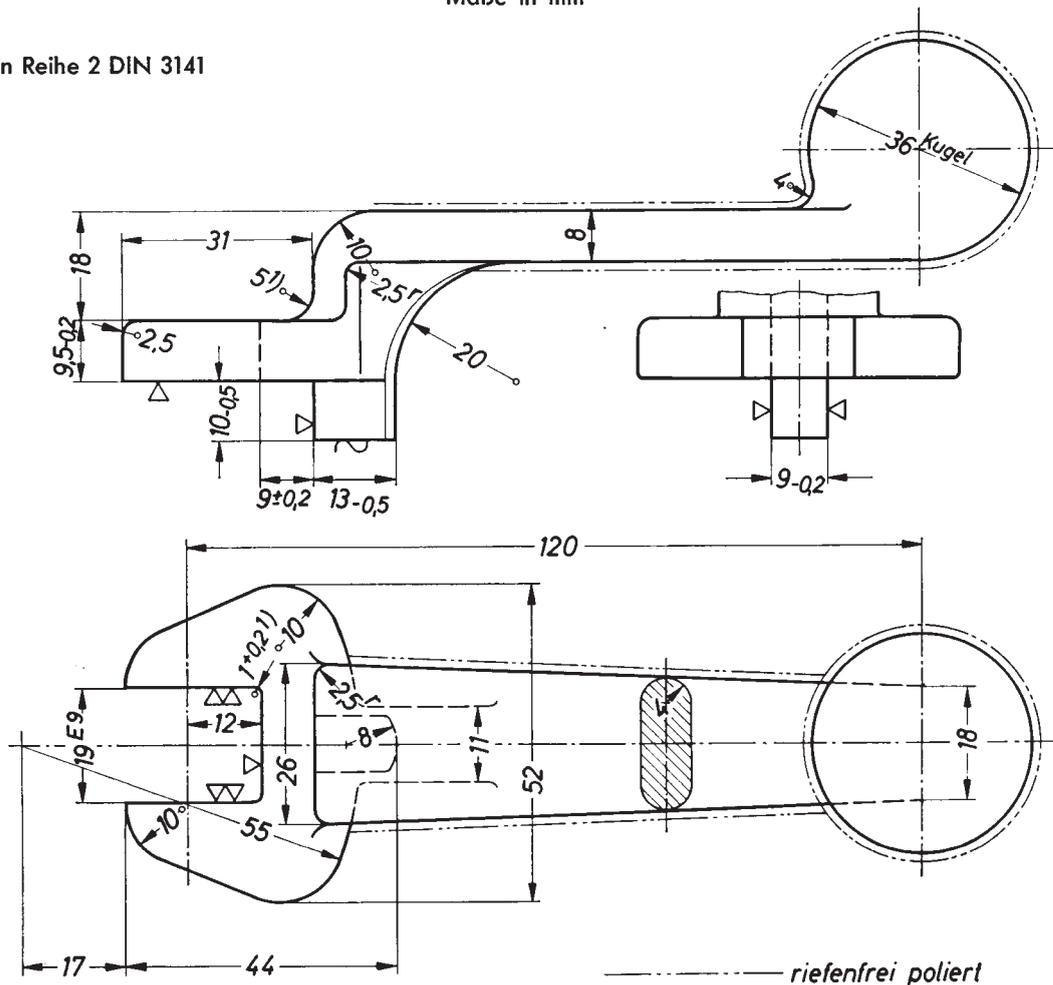
Bezeichnung eines Richtungshebels<sup>2)</sup> von 120 mm Länge aus GTW-40:
